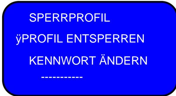
Geben Sie das aktuelle Passwort ein, um das Sensorprofil zu entsperren. Bei korrekter Passworteingabe wird folgende Erfolgsmeldung angezeigt.
