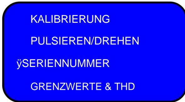
Mit den **yy** -Tasten kann der Cursor zwischen den sieben Ziffern bewegt werden und mit den **yy** -Tasten kann die gewünschte Seriennummer ausgewählt werden.
