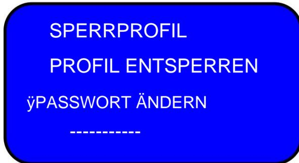
Wählen Sie mit den Tasten  $\ddot{y}$  und  $\ddot{y}$  das aktuelle Passwort aus.
