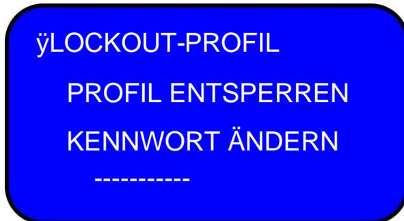
Geben Sie das aktuelle Passwort ein, um das Sensorprofil zu sperren. Bei korrekter Passwortheingabe wird die folgende Erfolgsmeldung angezeigt.
