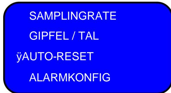
Wählen Sie mit den Tasten **↔** aus, ob die Funktion „Automatisches Zurücksetzen“ aktiviert oder deaktiviert werden soll.
