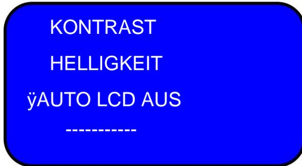
Mit den Tasten  $\ddot{y}$  aktivieren oder deaktivieren Sie die Funktion „Automatisches LCD-Ausschalten“. Der Timer für das automatische Ausschalten des LCD kann auf 1–15 Minuten eingestellt werden. Nach Ablauf dieser Zeit schaltet sich das LCD-Display automatisch aus, wenn es unbeaufsichtigt bleibt.
