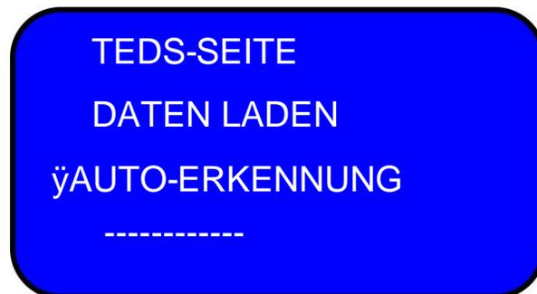
Verwenden Sie die Tasten  $\bar{y}$ , um die TEDS-Automatikerkennungsfunktion zu aktivieren oder zu deaktivieren
