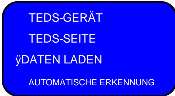
Die Option „Daten laden“ lädt das neue Profil basierend auf den TEDS-Daten und führt eine automatische Kalibrierung durch.
