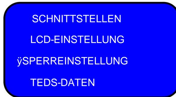
Über das Menü „Sperreinstellungen“ können Sie den Zugriff auf die Sensorprofileinstellungen und Daten steuern, die im internen, nichtflüchtigen Speicher (6.1.3.x und 6.1.4.x) gespeichert sind. Darüber hinaus können über das Menü „Sperreinstellungen“ die folgenden Untermenüs im Sensorprofilmenü gesteuert werden: Neu, Bearbeiten, Speichern, Löschen.
