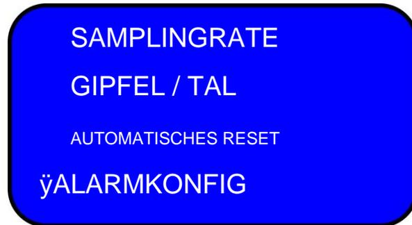
Stellen Sie mit den Tasten  $\ddot{y}$  die Alarmkonfiguration auf „Verriegelt“ oder „Nicht verriegelt“ ein.
