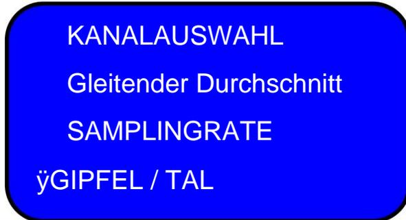
Wählen Sie mit den Tasten  $\ddot{y}$  die Anzeige der ersten Spitzen-/Talwerte oder die Anzeige der Spitzen-/Talwerte zum Halten aus.
