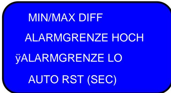
Bewegen Sie den Cursor mit den Pfeiltasten zwischen den Ziffern und wählen Sie die gewünschte Zahl für die untere Alarmgrenze aus. Bei der Konfiguration eines bidirektionalen Sensors kann das Vorzeichen auch von positiv auf negativ geändert werden.
